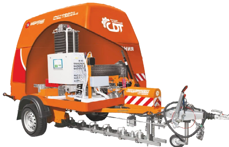
Рисунок 1 - Общий вид установки динамического нагружения ДИНА-4А
