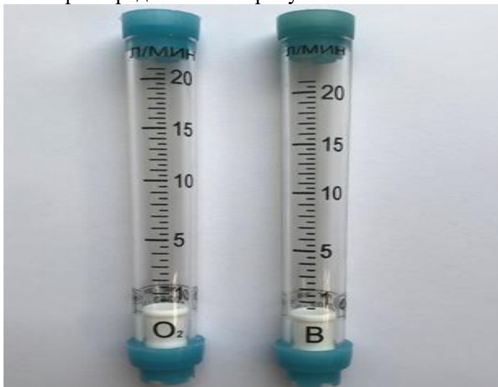
Рисунок 1 – Общий вид ротаметров медицинских газовых с местными показаниями «РМГ»
