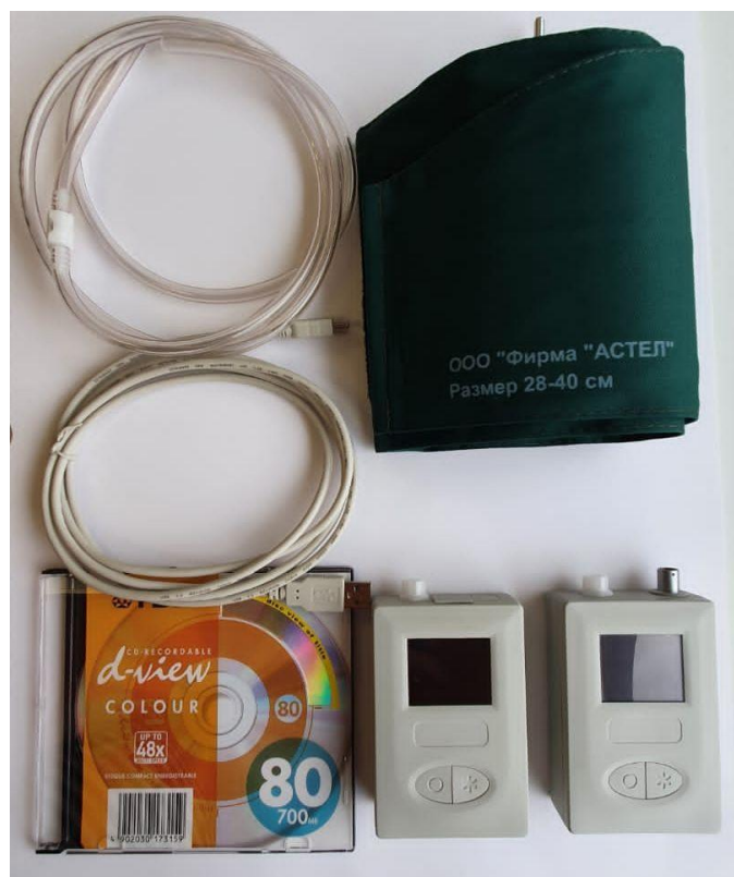
Рисунок 2 – общий вид комплексов суточного мониторинга ЭКГ и АД «КАРДИО-«Астел» с регистраторами типа 2 и 3 (без кабеля пациента ЭКГ)
