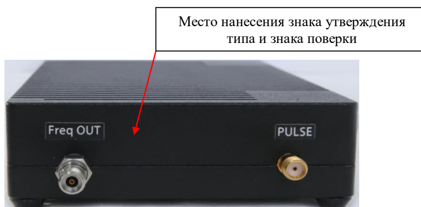
Рисунок 2 - Внешний вид передней панели модуля расширения частоты с обозначением мест нанесения знака утверждения типа и знака поверки
