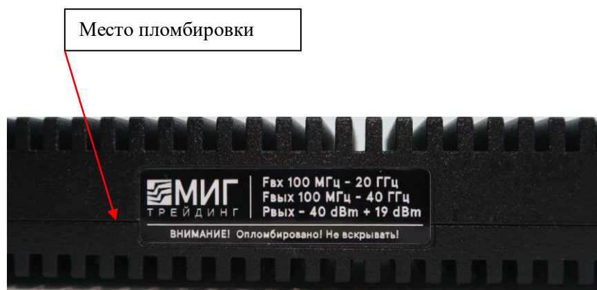
Рисунок 3 – Место пломбирования модуля расширения частоты
