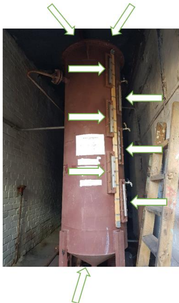
Рисунок 2 – Схема пломбировки мерника ММВ-70У, зав.№ 11 от несанкционированного доступа, обозначение места нанесения знака поверки
