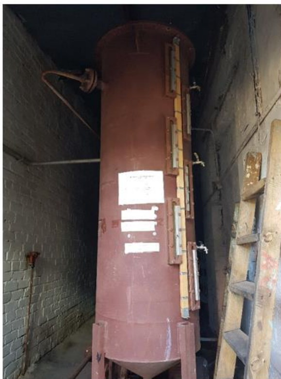
Рисунок 1 - Общий вид мерника ММВ-70У, зав.№ 11
