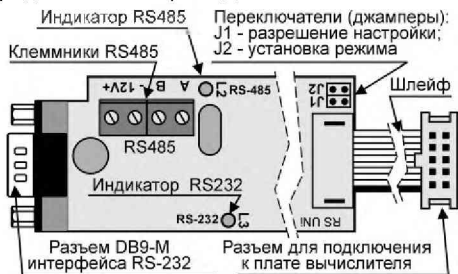
Рис. Д.1 – Внешний вид платы универсального адаптера интерфейсов
