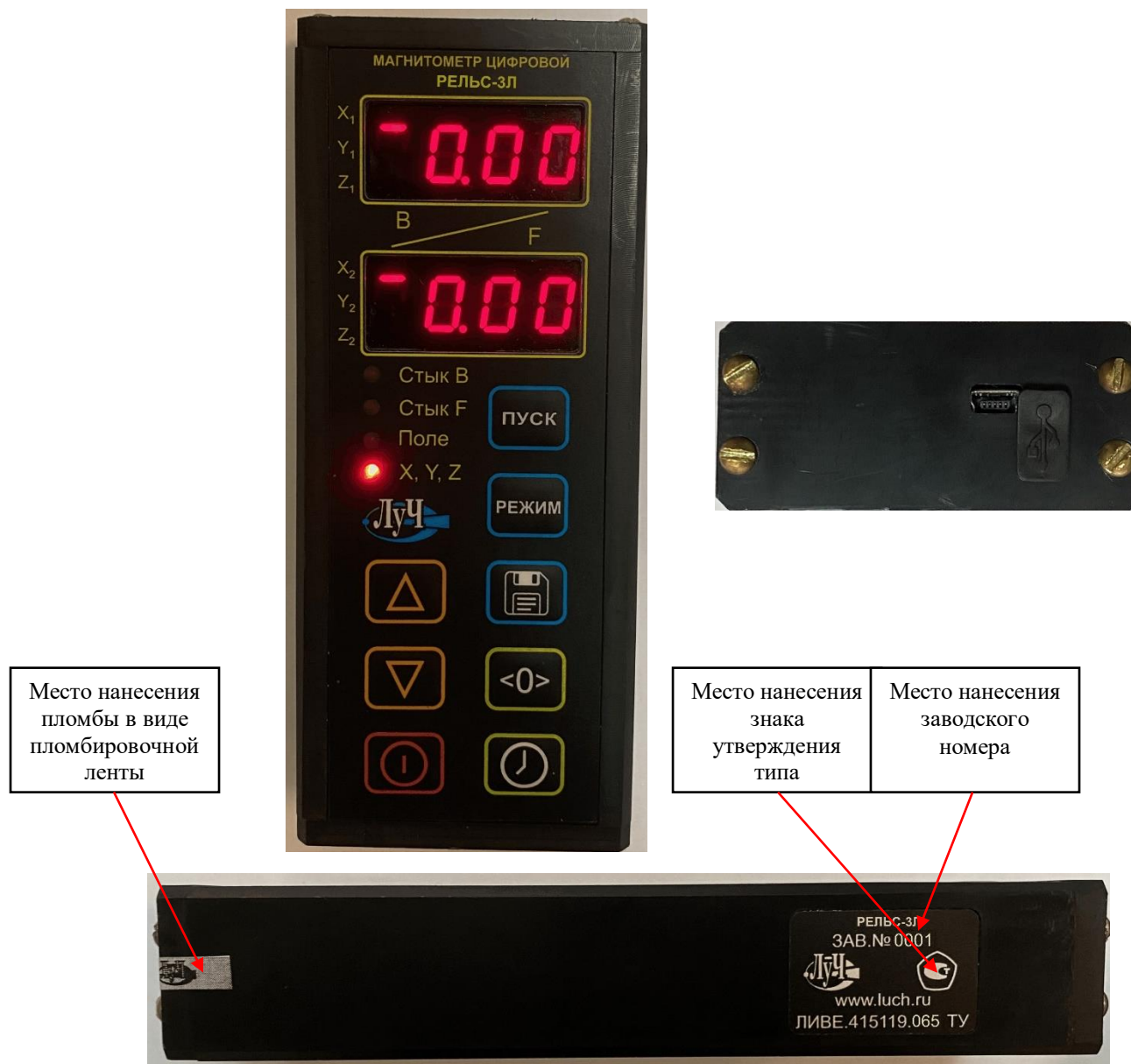
Рисунок 1 – Общий вид магнитометра РЕЛЬС-3Л с указанием мест пломбировки (для пломбировочной ленты), мест нанесения знака утверждения типа, заводского номера
