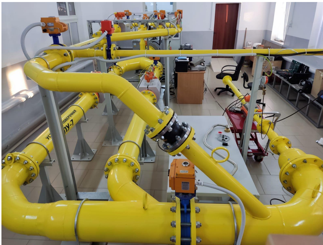
Рисунок 1 – Общий вид установки поверочной СПУ-7
