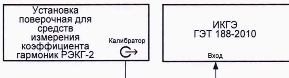
Рисунок 1 - Схема соединений для проверки погрешности воспроизведения КГ установкой РЭКГ-2
