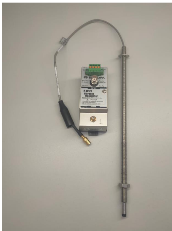
Рисунок 1 – Общий вид преобразователей
