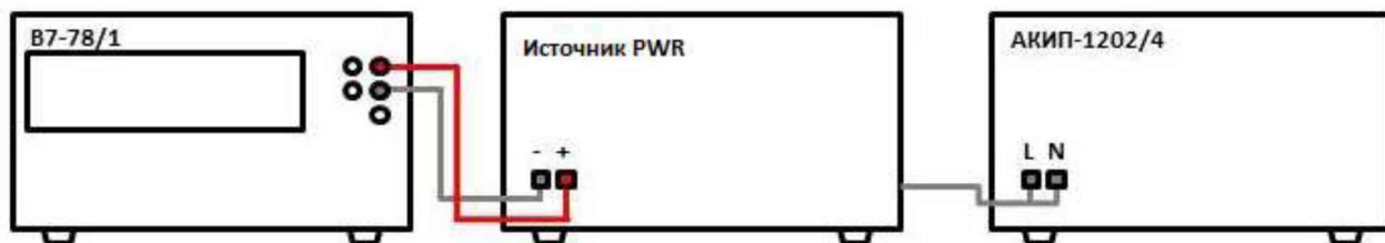
Рисунок 1 – Схема соединения приборов для определения погрешности установки/измерений напряжения постоянного тока
