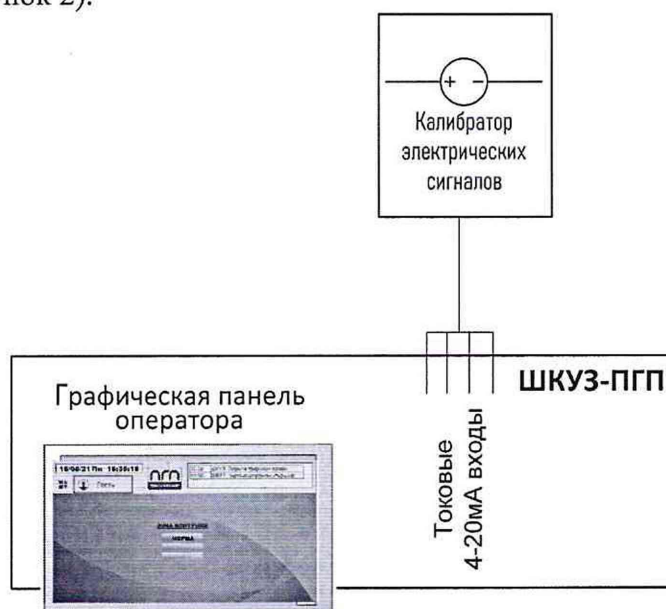
Рисунок 2 – Схема поверки измерительного канала с ПИП с аналоговым выходом
