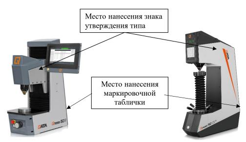
Рисунок 1 —Общий вид твердомеров Роквелла Qness 150 R
