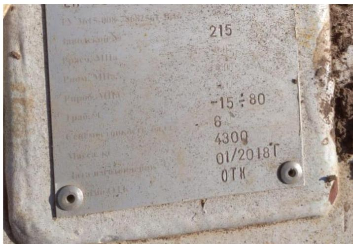
Рисунок 1 – Место нанесения заводского номера
