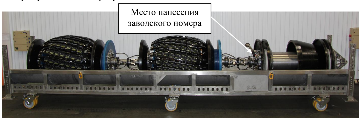
Рисунок 1 – Общий вид дефектоскопа внутритрубного ультразвукового 40-ДФР.00-00.000
