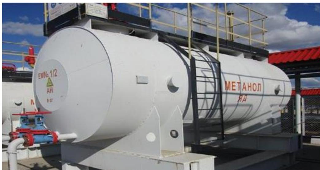
Рисунок 1 – Общий вид резервуаров горизонтальных стальных цилиндрических РГС-16
