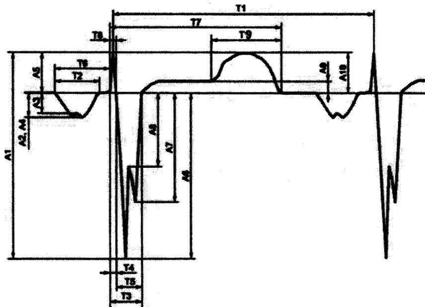
A1 – размах сигналов; A2 – амплитуда зубца P; A4 – амплитуда зубца P; A5 – амплитуда зубца R; A6 – амплитуда зубца S; A10 – амплитуда зубца T; T1 – интервал RR; T2 – зубец P; T3 – комплекс QRS; T4 – зубец R; T5 – зубец S; T6 – интервал PQ (PR); T7 – интервал QT; T8 – интервал внутреннего отклонения  $QR_{max}$ ; T9 – зубец T
