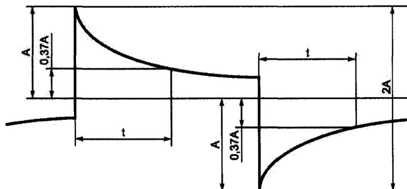
Рисунок – 1 Определение постоянной времени
