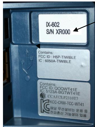
Рисунок 2 – Маркировка тахеометров электронных SOKKIA iX
