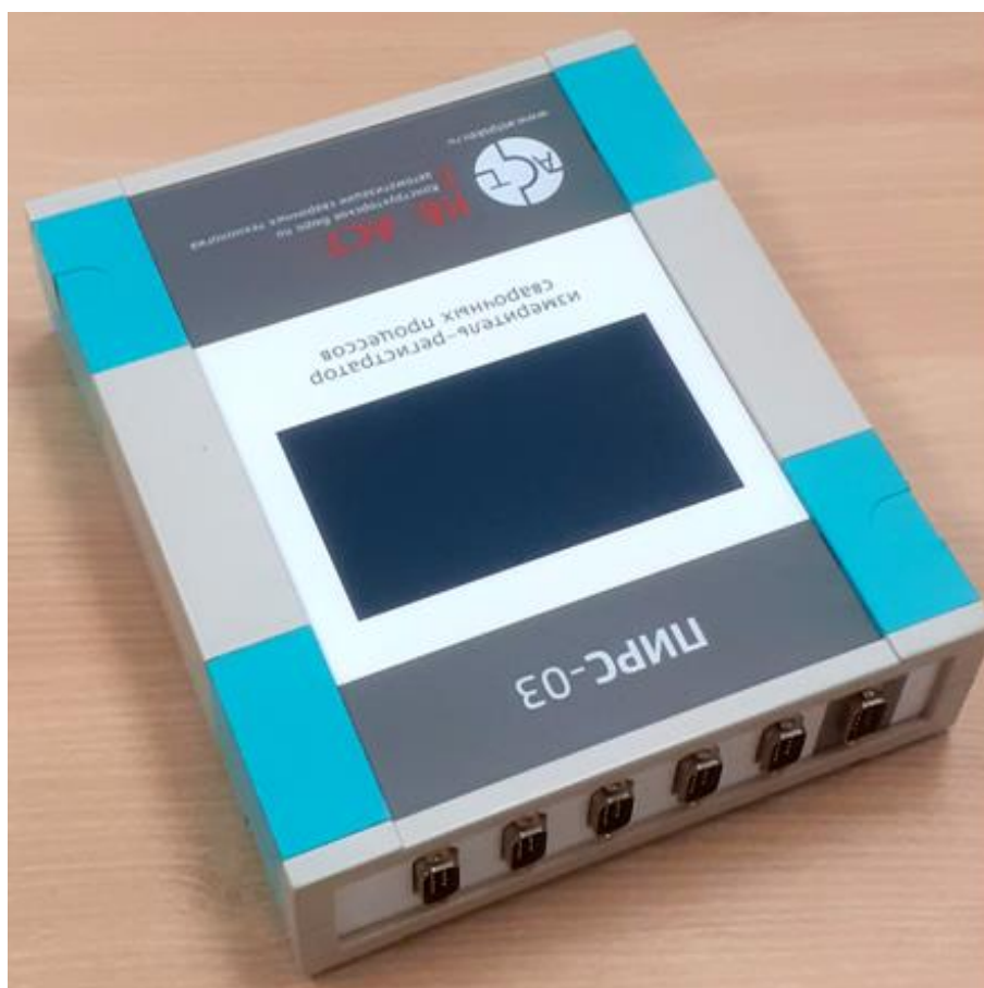
Рисунок 2 – Общий вид измерителей-регистраторов сварочных процессов ПИРС-03
