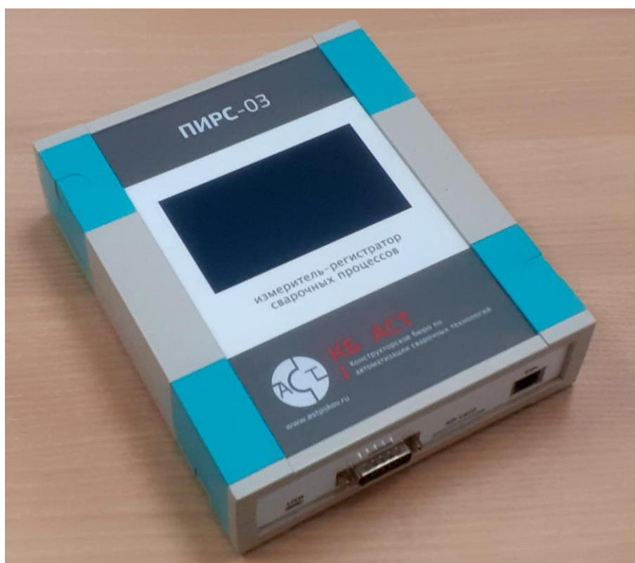
Рисунок 1 – Общий вид измерителей-регистраторов сварочных процессов ПИРС-03
