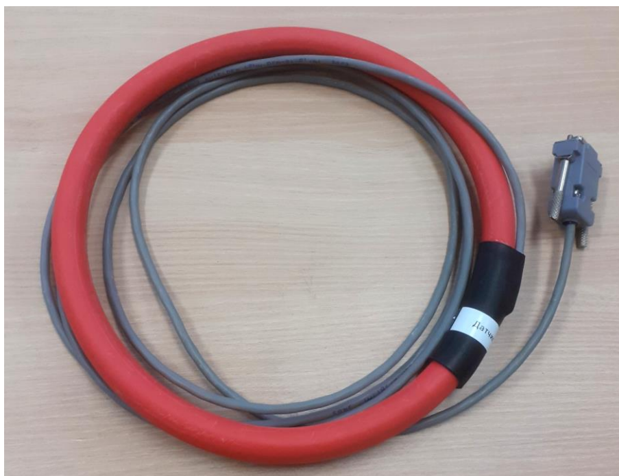
Рисунок 3 – Общий вид датчика тока типа «Пояс Роговского»
