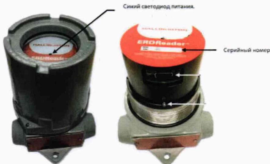
Включить WiFi на телефоне или компьютере, выбрать из списка сетей COREREADER\_XXX, где X серийный номер блока вывода данных (ERD Reader). Ввести пароль «corereader» нижним регистром (строчными буквами). Далее открыть браузер (например Internet Explorer), в строке адреса ввести 192.168.9.1 и перейти, в окне авторизации ввести юзернейм admin, пароль admin соблюдая нижний регистр.
