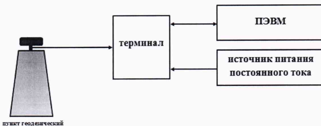
Рисунок 2 – Схема для проведения измерений при определении погрешностей определения координат местоположения и скорости на пункте геодезическом.
