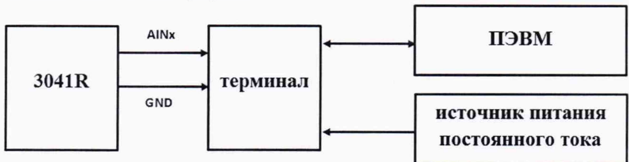
Рисунок 3 – Схема подключения приборов для определения диапазона и абсолютной погрешности измерений напряжения постоянного тока
