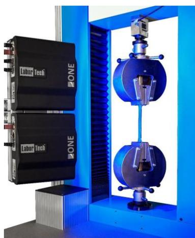
Рисунок 3 – Общий вид подключения двух измерителей
