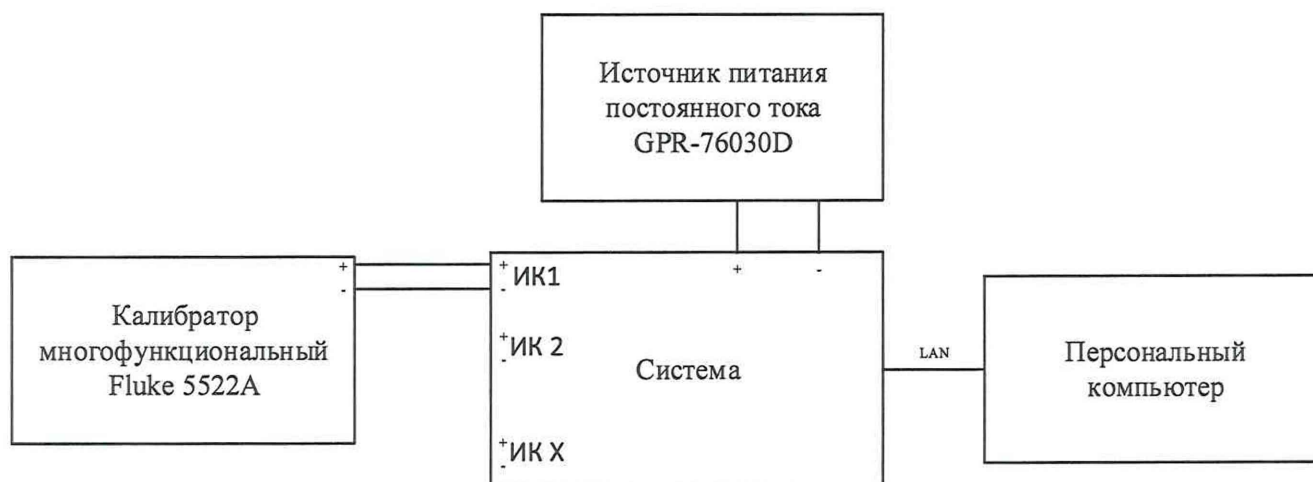
Рисунок 1 – Схема определения относительной погрешности измерений напряжения постоянного тока
