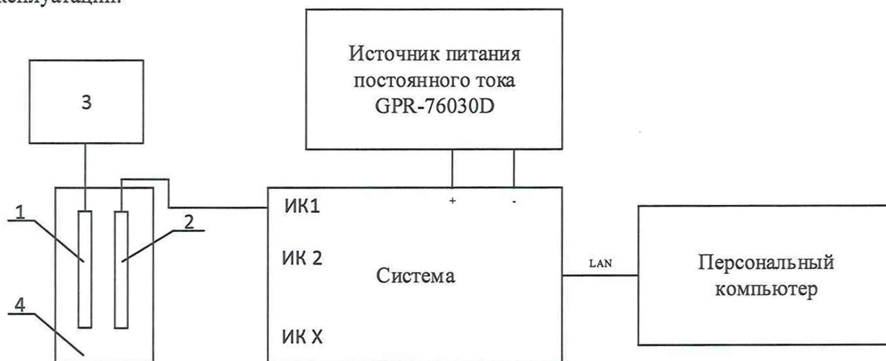
Рисунок 2 – Схема определения приведенной (к диапазону) погрешности измерений температуры (1 – термометр, 2 – чувствительный элемент системы, 3- измеритель, 4 - термостат)
