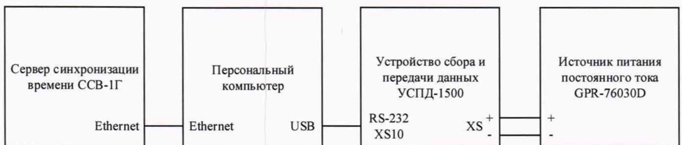
Рисунок 2 – Схема определения подключения приборов при определении основной абсолютной погрешности хода внутренних часов в автономном режиме за сутки
