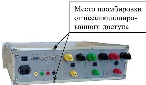
Рисунок2 –Места пломбировки блока измерений
