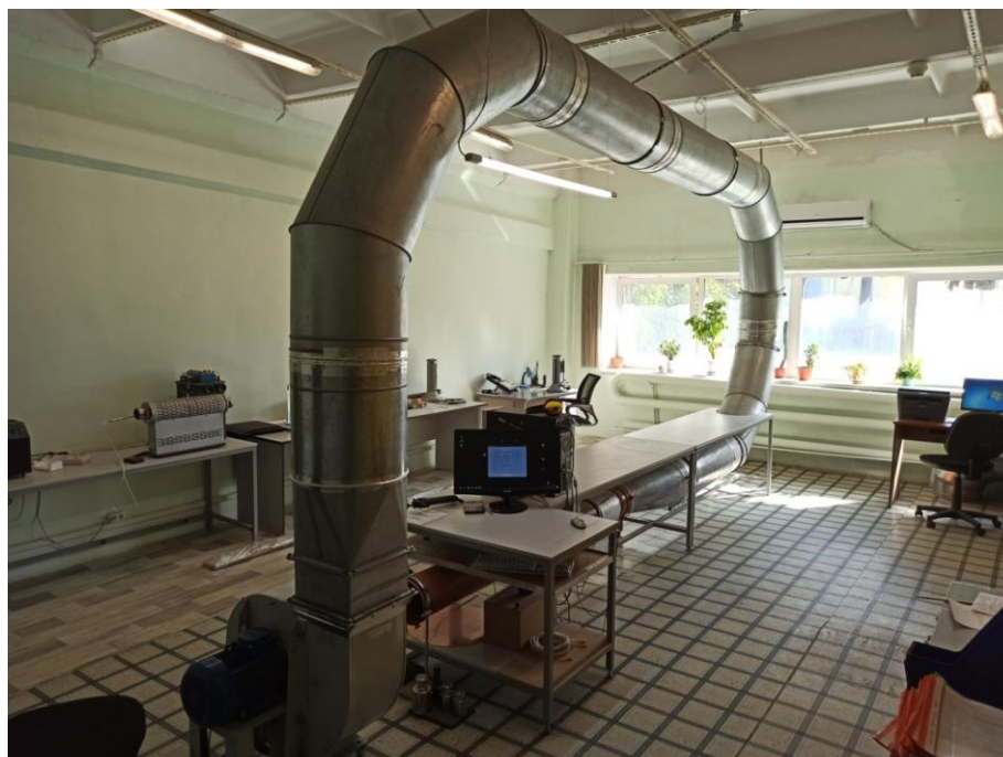
Рисунок 2 - Общий вид трубы аэродинамической АТБ-2
