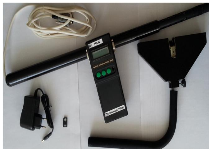
Рисунок 3 – Общий вид приборов для измерения дымности в отработавших газах транспортных средств «Дымомер НСК» модификации НСК-02
