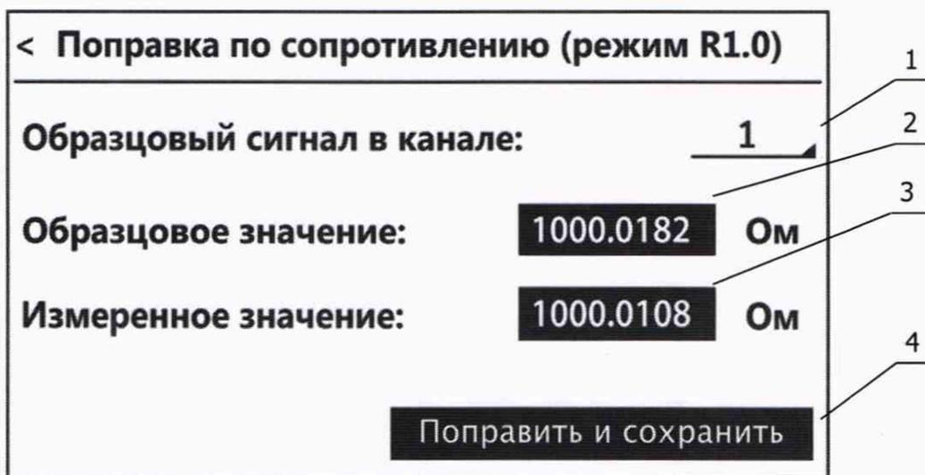
Рисунок 5 — Окно поправки опорного сопротивления
