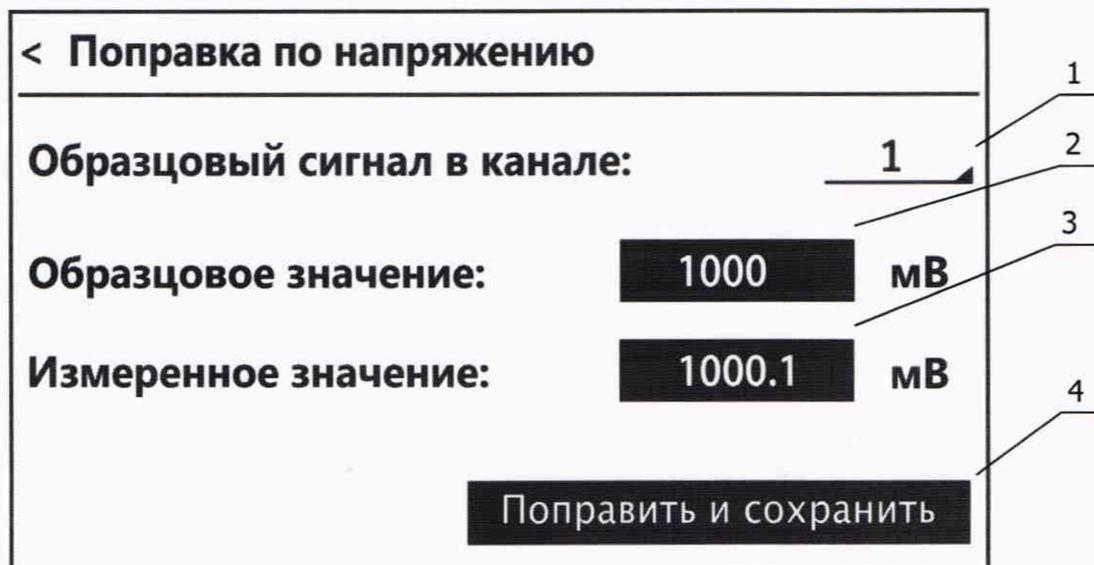
Рисунок 4 — Окно поправки опорного напряжения
