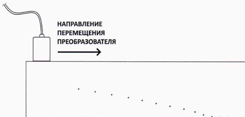
Рисунок 4 – Положение преобразователя на поверхности меры МД 2-0-1
