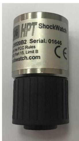
Рисунок 3 - Общий вид внешнего комбинированного датчика НРТ
