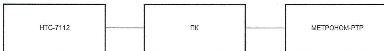
Рисунок 7 – Схема подключений при определении погрешности хранения собственной шкалы времени (без коррекции от источника точного времени)
