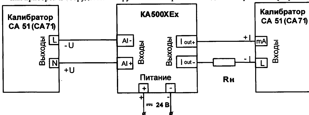
Рисунок 6.4.1.2 – Подключение барьеров мод. КА500ХЕх для поверки входных сигналов напряжение постоянного тока, выходной сигнал-ток от 4 до 20 мА
