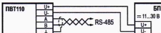
Рисунок Б3 - Схема подключения преобразователя с цифровым выходным сигналом
