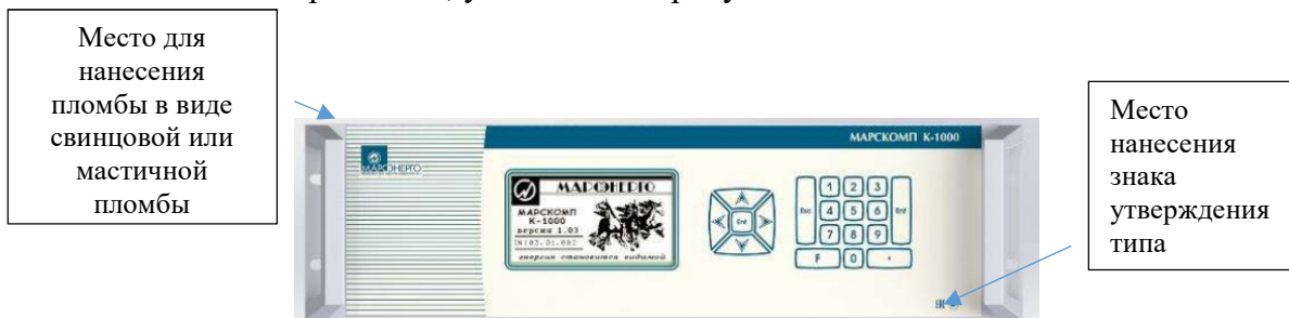
Рисунок 1 – Общий вид стационарных компараторов модификации «Марскомп К-1000 С» с указанием мест пломбировки (для свинцовой пломбы или мастичной пломбы), мест нанесения знака утверждения типа.
