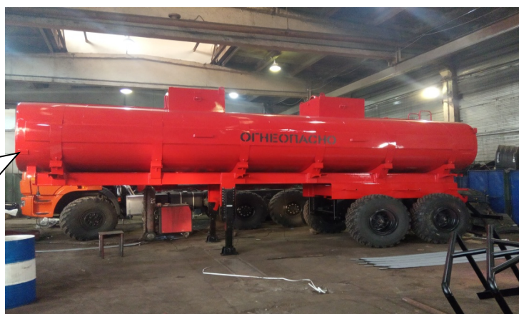
Рисунок 4 – Общий вид ППЦ с двумя секциями
