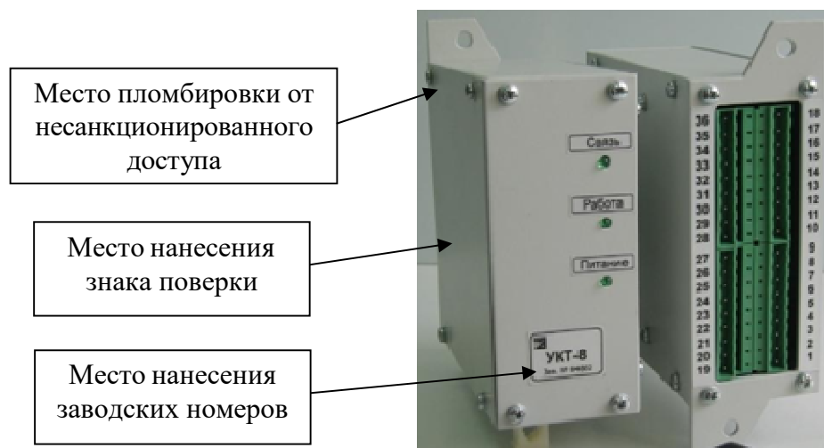
Рисунок 2 – Общий вид устройств модификации УКТ-8, мест пломбировки от несанкционированного доступа, обозначение места нанесения знака поверки, заводских номеров
