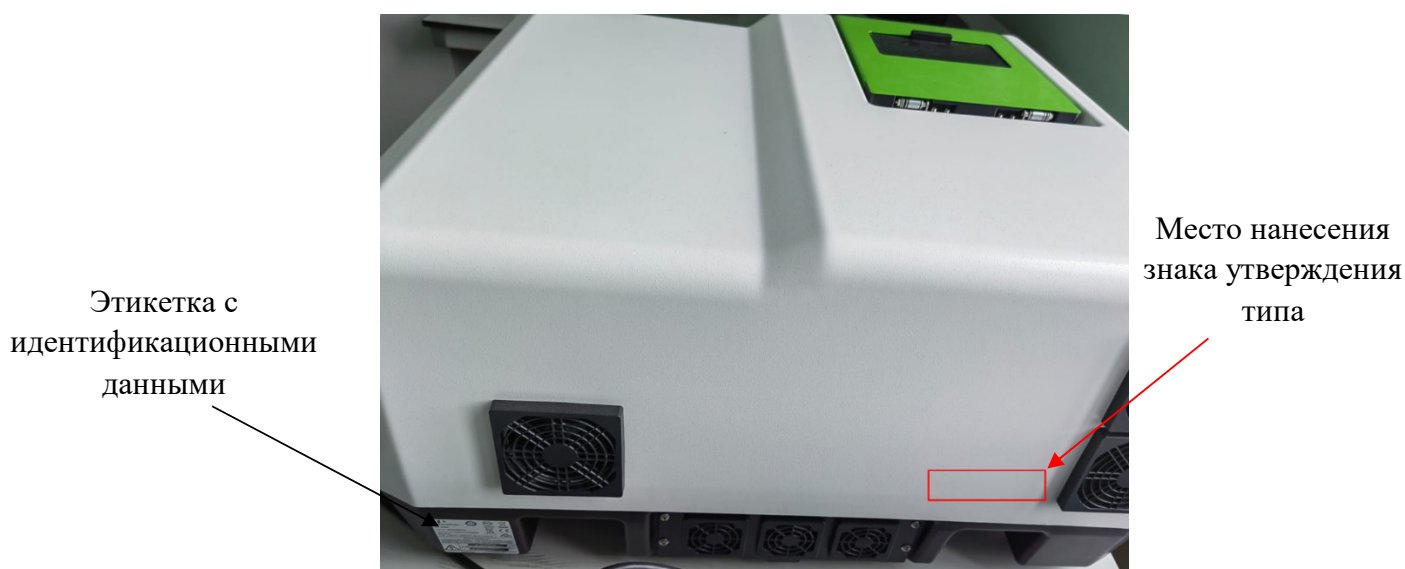
Рисунок 2 – Задняя панель спектрофлуориметров FL6500 и FL8500 с указанием мест нанесения идентификационных данных, включая дату изготовления, и знака утверждения типа
