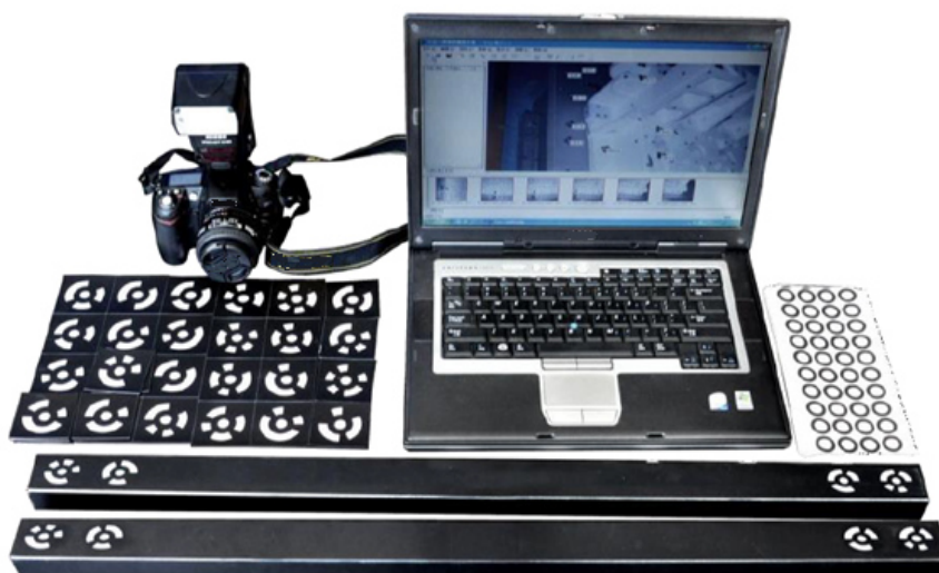
Рисунок 2 – Состав устройства FS: компьютер, камера, цифровое фотограмметрическое ПО, кодированные маркеры, высокоточная измерительная линейка, целевые маркеры
