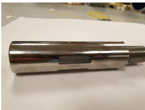
Рисунок 3 – Общий вид сигнализатора метана
