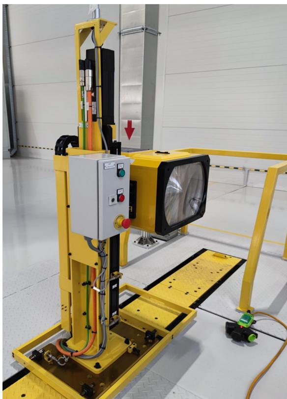
Рисунок 1 – Общий вид прибора для измерений параметров света фар автотранспортных средств FORI FV-2018 HDGT
