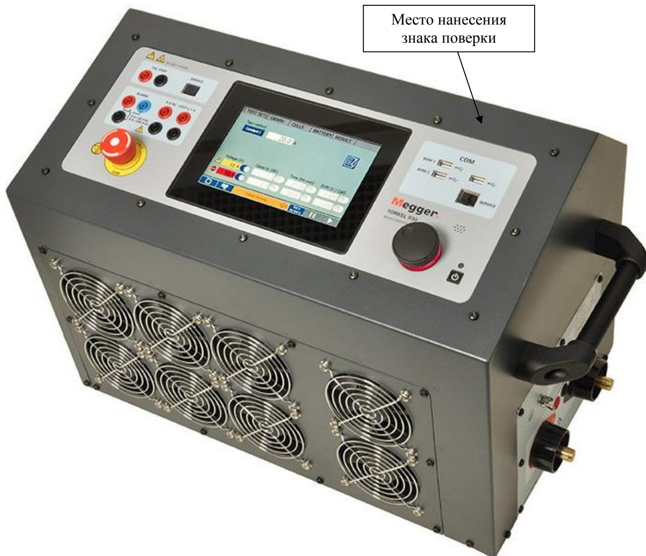
Рисунок 1 – Общий вид измерителей параметров аккумуляторных батарей TORKEL 930
