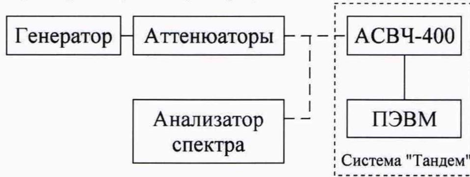
Рисунок 6 – Схема измерений динамического диапазона измерений уровня синусоидального сигнала, максимального измеряемого уровня мощности синусоидального сигнала, абсолютной погрешности измерения уровня мощности синусоидального сигнала
