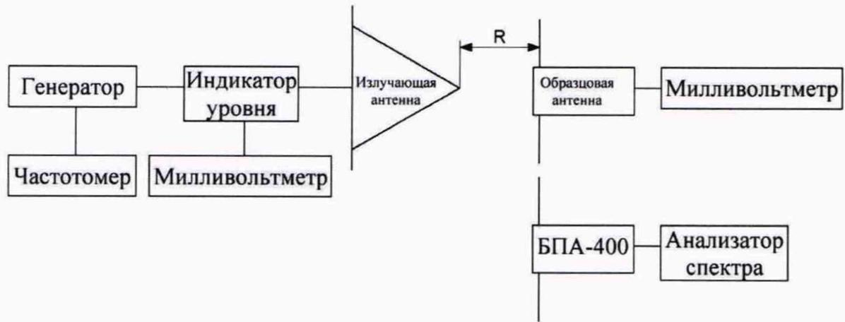
Рисунок 7 – Схема измерений коэффициента калибровки антенны
