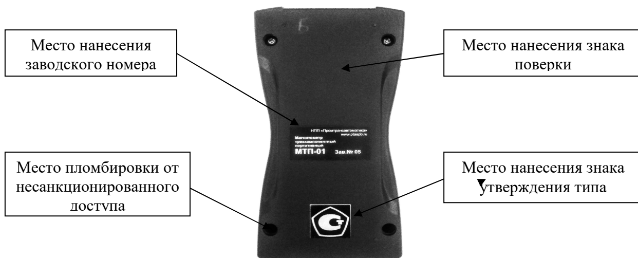
Рисунок 2 – Общий вид задней стенки корпуса магнитометра с указанием мест пломбировки, мест нанесения знака утверждения типа, знака поверки, заводского номера
