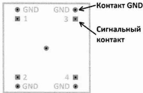
Рисунок 13 – Контакты для калибровки устройства ТСКЯ.418133.416
