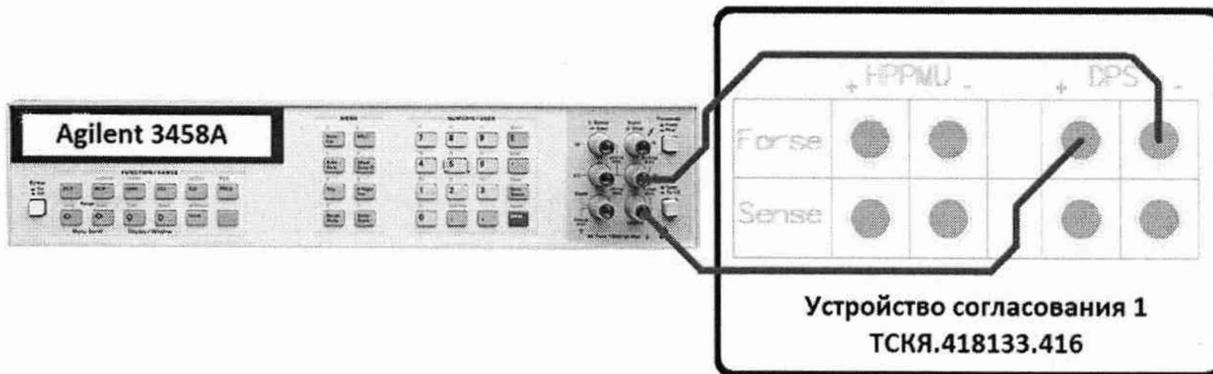
Рисунок 25 – Схема определения погрешности воспроизведения силы тока источником питания DCS DPS128
