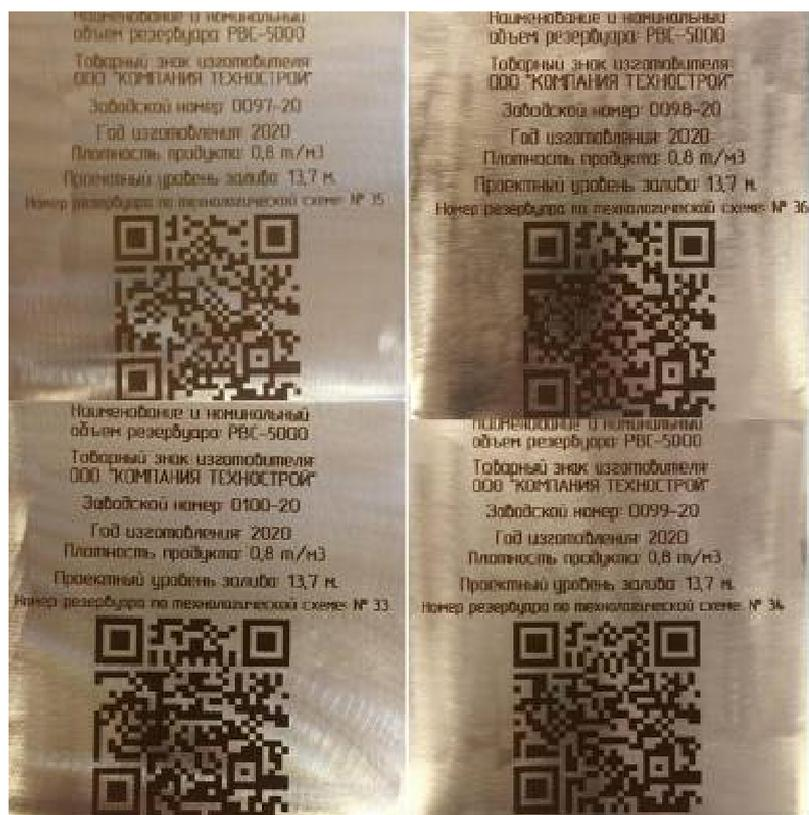
Рисунок 2 – Металлические таблички с заводскими номерами РВС-5000
