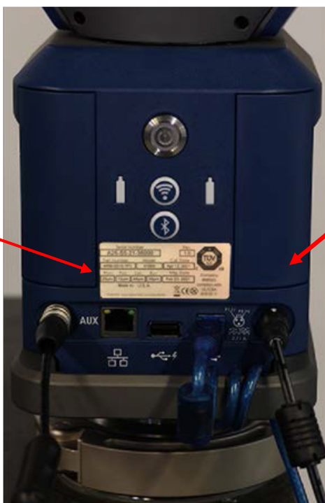
Рисунок 4 – Места нанесения маркировочной наклейки с заводским номером и знака утверждения типа средства измерений
