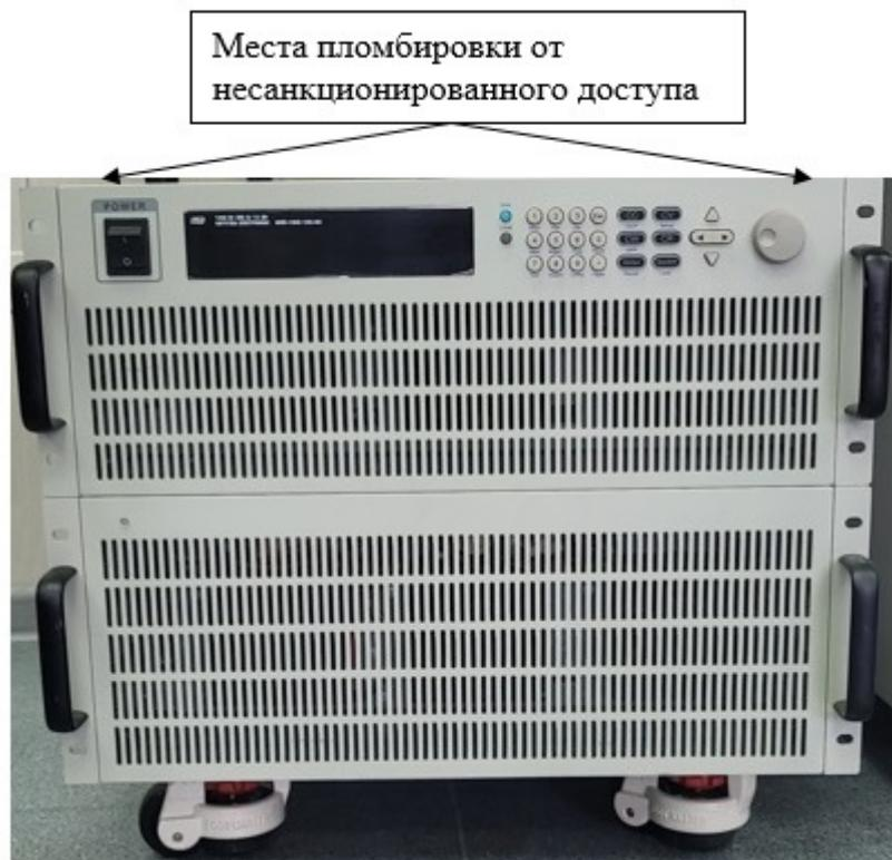
Рисунок 1 – Общий вид лицевой панели нагрузки электронной программируемой АКПП-1366Е-1200-480 с указанием мест пломбировки
