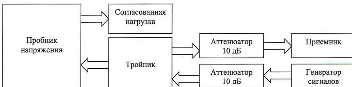
Рисунок 1 - Схема калибровки выходного уровня генератора сигналов
