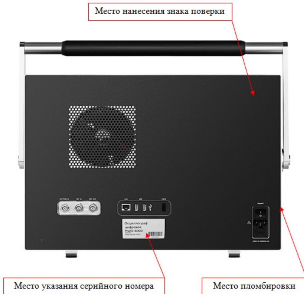
Рисунок 2 – Схема пломбировки от несанкционированного доступа, место нанесения серийного номера, идентифицирующего каждый экземпляр СИ, место нанесения знака поверки
