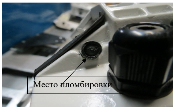
Рисунок 3 – Схема пломбировки видео модуля
